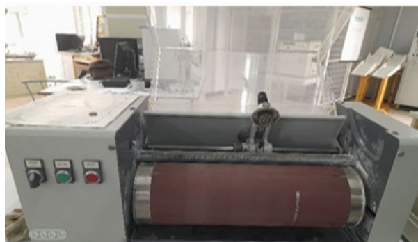
Figure 1. DIN abrasion test apparatus.
